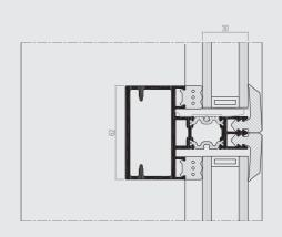
El CW 60-DRL es un sistema para muros cortina con rotura de puente térmico. El acristalado se fija mediante juntas de silicona preformadas. Esto convierte al sistema CW 60-DRL en una solución óptima para el acristalamiento y le da a la fachada un apariencia enrasada exclusiva.
