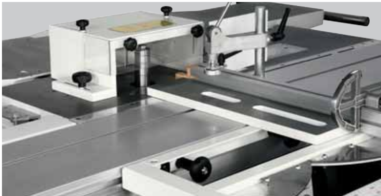
GUÍA TUPÍ REGULABLE A 3 DESPLAZAMIENTOS La guía tupí puede desplazarse y volver a posicionarse con facilidad sin perder la posición de trabajo, gracias al sistema de memorias. La guía, además, utiliza un sistema de regulación mediante cremallera y dispone de un lector digital mecánico.
