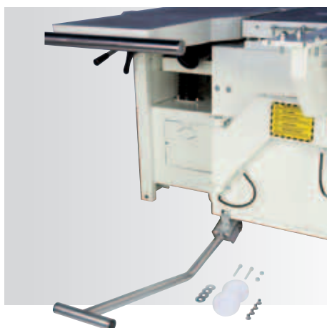
Grupo ruedas integrado en la base, para desplazar con facilidad la máquina. (Nota: No disponible solamente sobre las ST4)
