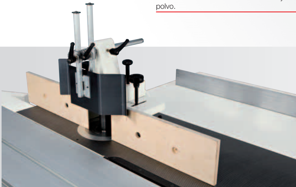
Campana tupí con ajuste micrométrico de la posición
