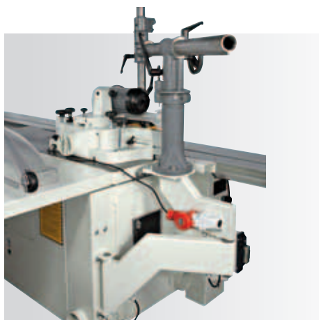
Predisposición eléctrica y soporte excluible para alimentador
