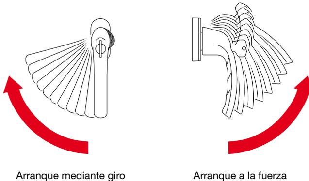
La tecnología Secu100® impide que la manilla sea arrancada ni extraída del cuerpo de la roseta, resistiendo hasta un momento de torsión de 100 Nm
