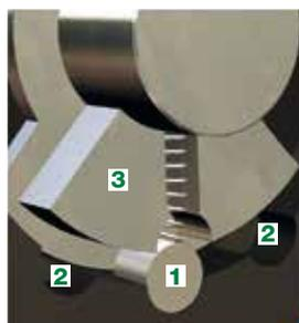
Al intentar forzar la ventana, los tetones de seguridad **1** son presionados por un segundo dispositivo de acoplamiento **3** al interior de las entalladuras de la carcasa **2**.
