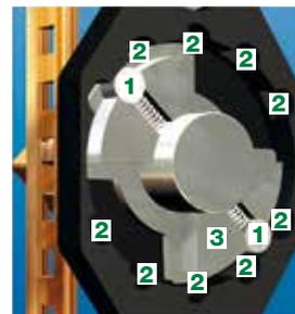
Durante el giro, el dispositivo de acoplamiento **1** arrastra consigo los tetones de seguridad **3** a las otras entalladuras **2**, donde vuelven a encajar de forma audible.
