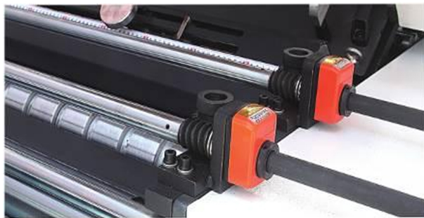
Reguladores de presión con pantalla de indicador de cuadrante.
