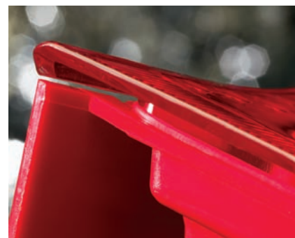
El precalentamiento permite retrasar la vibración hasta el estado viscoso, evitando las partículas resultantes de la fricción de vibración seca de sólido a sólido.
