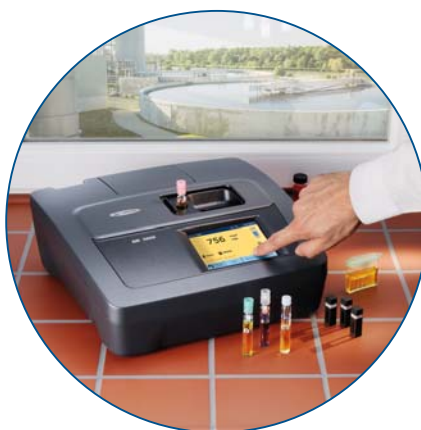
Fig. 3: Espectrofotómetro DR 3800 sc con sistema de lectura de códigos de barras (IBR), pantalla a color TFT, pantalla táctil, etc., para 230 métodos HACH LANGE preprogramados y 50 métodos programados por el usuario.
