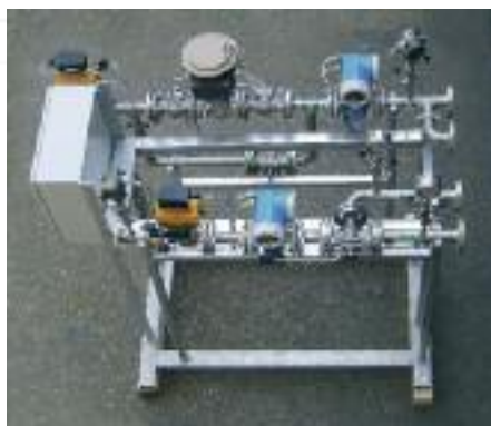
Estación de regulación con cableado a la caja de bornes
