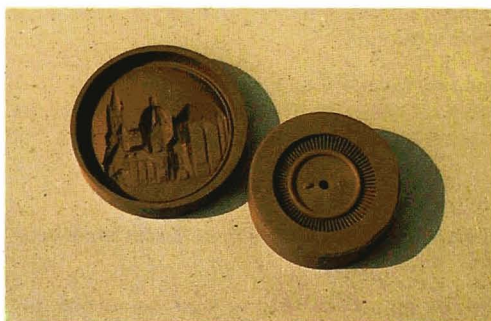
"flex-unit" como material de colada elástico para matricería. Reproducción de los más finos detalles. Con propiedades parecidas a las del caucho de silicona.
