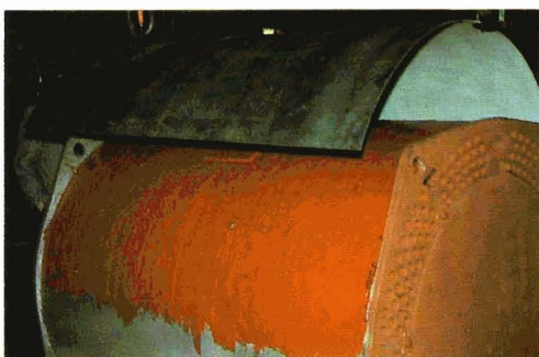
Revestimientos "flex-unit" aíslan eficazmente contra vibraciones. Aquí, como revestimiento de absorción acústica entre carcasa y cubierta de un motor eléctrico.
