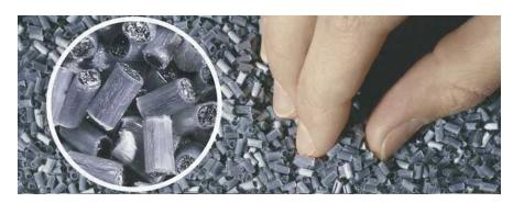
Las fibras metálicas se componen de microscópicos alambres inoxidables con un diámetro de aprox.  $8~\mu$  y una longitud de aprox. 5~mm.
