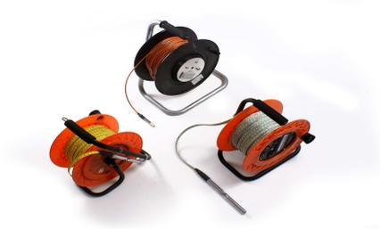
Sondas de medición nivel freático
