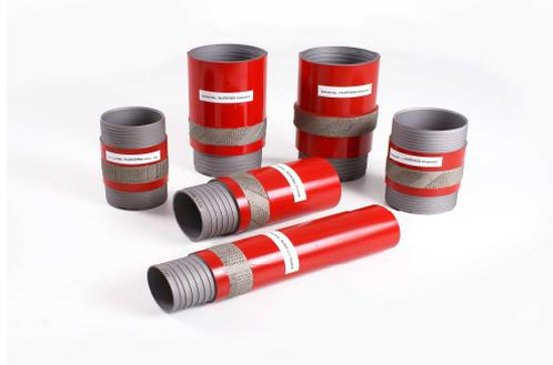
Diseñados con un diámetro exterior mayor al de la corona, aseguran un diámetro constante del pozo aunque la corona pierda diámetro exterior.
