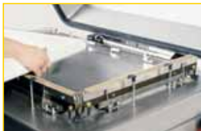
EVA-9-11. Fácil extracción de la cinta transportadora para su limpieza.
