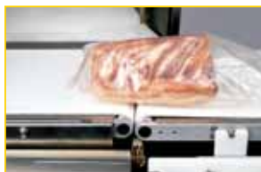
PA-9-11. La nivelación automática de las dos cintas, facilita el desplazamiento del producto, asegurando una perfecta colocación.
