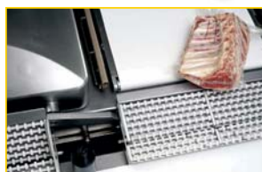
EVD-A-20. Expulsión automática del producto una vez terminado el ciclo de envasado al vacío.
