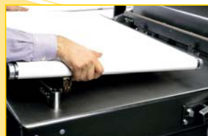
EVD-A-20. Fácil extracción de la cinta transportadora para su limpieza.
