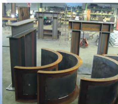
Paneles forrado celdas
