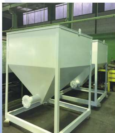
Tolva tratamiento de aguas
