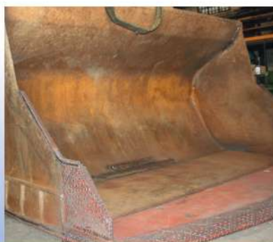
Recubrimiento antidesgaste a cazo pala
