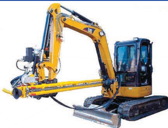
EQUIPO DE 2 MARTILLOS MS-90 CON CESTA MS-90 BACKHOE LOADER WITH 2 HAMMERS AND BASKET
