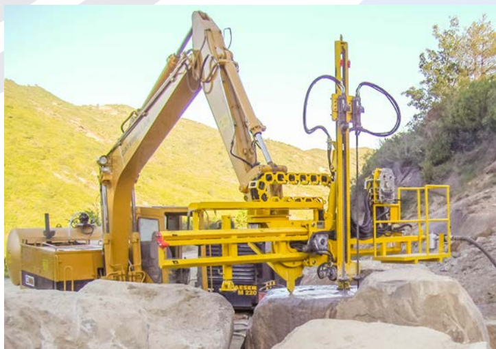
EQUIPO DE 2 MARTILLOS MS-90 CON CESTA MS-90 BACKHOE LOADER WITH 2 HAMMERS AND BASKET
