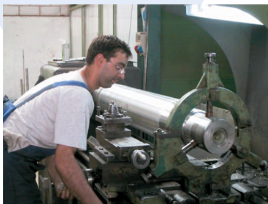
REPARACIÓN EJE/ SHAFT REPAIR
