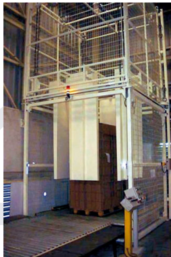
APILADOR DE CARTÓN PARA EMBALAJE CARDBOARD STACKER FOR PACKAGING
