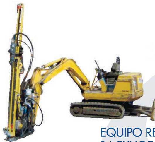
EQUIPO DE 2 MARTILLOS MS-90 CON CESTA MS-90 BACKHOE LOADER WITH 2 HAMMERS AND BASKET
