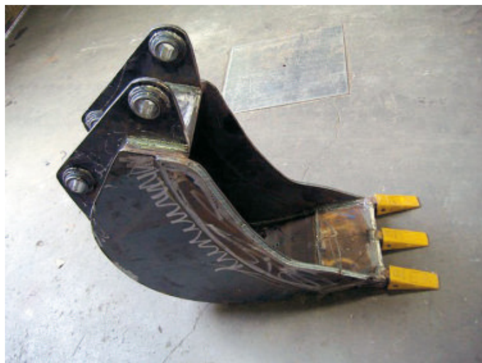
REPARACIÓN DE CAZO DE PALA
