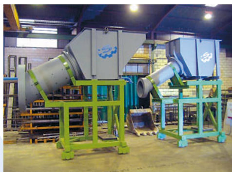
TOMA DE TRANSICIÓN DE MOLINOS SAG BALL SAG BALL GRINDER TRANSFER INTAKE
