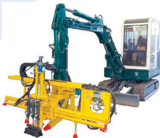
EQUIPO DE 2 MARTILLOS MS-90 CON CESTA MS-90 BACKHOE LOADER WITH 2 HAMMERS AND BASKET
