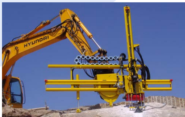
EQUIPO DE 2 MARTILLOS MS-90 CON CESTA MS-90 BACKHOE LOADER WITH 2 HAMMERS AND BASKET
