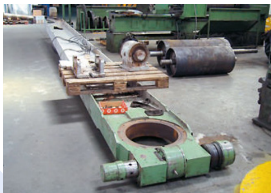
BIELA DE TELAR / GANGSAW ROD
