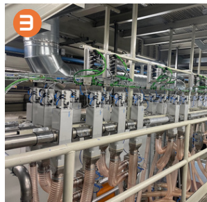
3 Válvula de selección individual de material (VDL).
