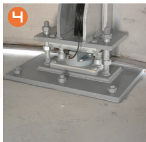
Control de stocks mediante pesaje (células de carga) Precisión: \pm 150 kg
