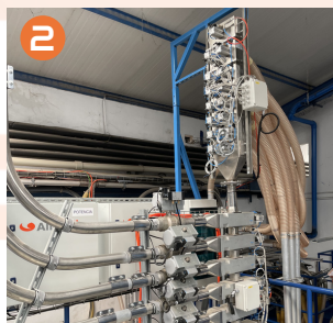
2 Sistema automático de selección de material (Multivía).
