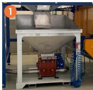
1 Sistema impulsión/carga de silos Capacidad: hasta 10 ton / hora
