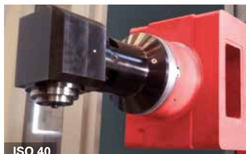
AV Cabezal vertical automático para el mecanizado de piezas que tengan pequeños espacios interiores
