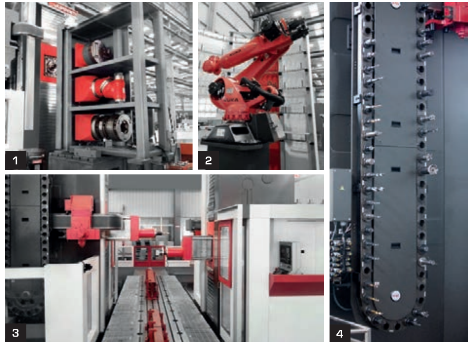
1. Cambiador de cabezales AAC. 2. Cambiador de herramientas ATC tipo robot. 3. Configuración dúplex. 4. Almacén de herramientas tipo cadena.
