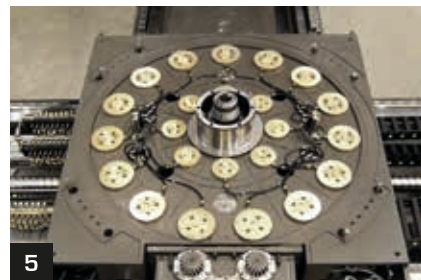
1. Estructura termosimétrica con cabezal central. 2. Múltiples opciones de automatización. Detalle del robot ATC. 3. Desplazamiento vertical del cabezal con cuatro guías: 2 delante y 2 detrás. 4. Estructura robusta y componentes de máxima precisión. 5. Guiado hidrostático con doble piñón sin holgura para el giro de mesa.
