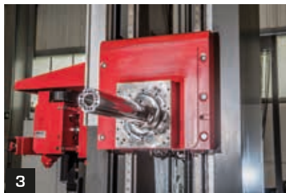
1. Estructura termosimétrica con cabezal central. 2. Múltiples opciones de automatización. Detalle del robot ATC. 3. Desplazamiento vertical del cabezal con cuatro guías: 2 delante y 2 detrás. 4. Estructura robusta y componentes de máxima precisión. 5. Guiado hidrostático con doble piñón sin holgura para el giro de mesa.
