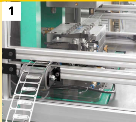
1 Procedimiento reel to reel: sobreinyección perfecta de bandas portadoras (leadframes).
