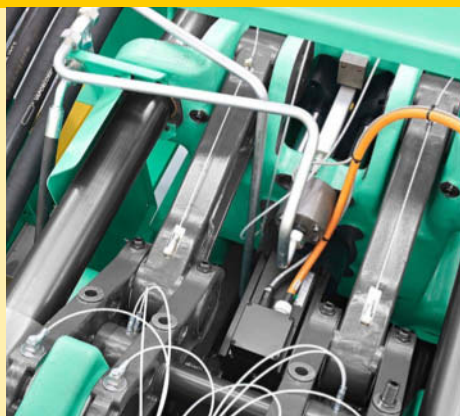
Rápida, precisa, eficiente energéticamente: unidad de cierre servoeléctrica con rodillera.
