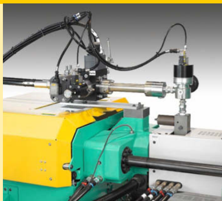
Exacta: atemperación hidráulica y alimentación de material adaptada.
