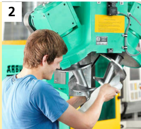
2 Husillo doble INJESTER: limpieza rápida mediante un desmontaje sencillo.
