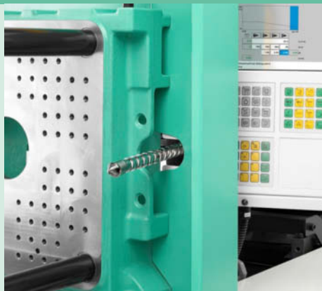
Fácil mantenimiento: cambio del husillo con unidad de inyección basculante.
