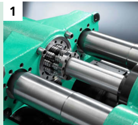
Precisión absoluta: Accionamiento con engranaje planetario en las ALLROUNDER A.
