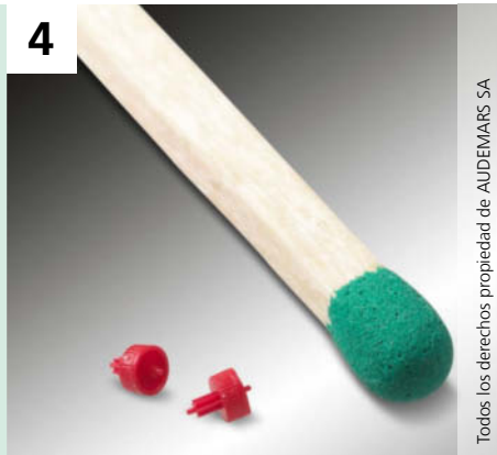
Micromoldeo por inyección: pesos de inyectada mínimos mediante el módulo de microinyección.
