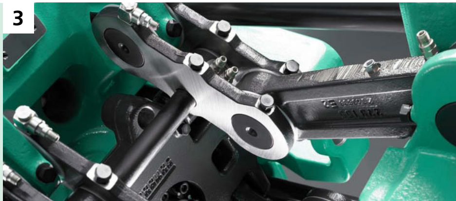
Fácil mantenimiento: engrase central automático de la unidad de cierre en función del rendimiento.
