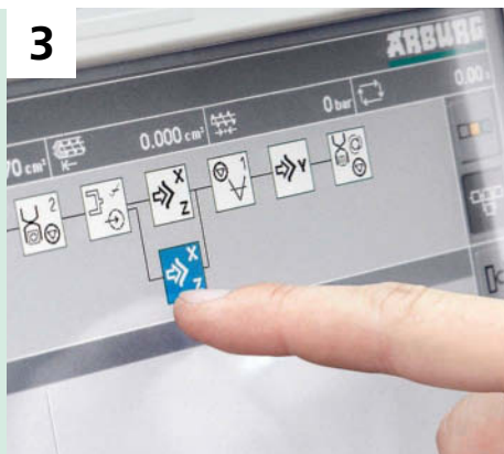
3 Capacidad de integración: una única unidad de pilotaje para la ALLROUNDER y el sistema de robot.
