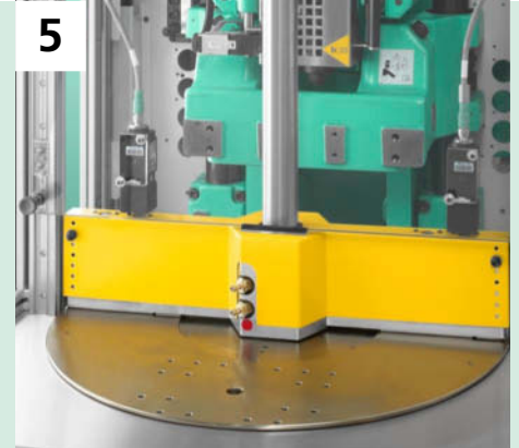
5 Eficiencia: producción de alta calidad con la mesa giratoria servoeléctrica.
