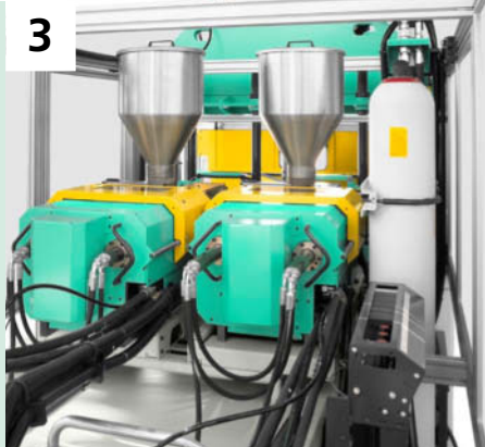
3 Alta potencia: movimientos rápidos simultáneos con la tecnología de acumuladores hidráulicos.
