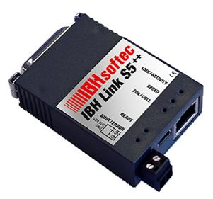
El IBH Link S5++ es un convertidor de Ethernet robusto, incorporado en un conector de 15 pin para su conexión directa al puerto de programación del autómata.
