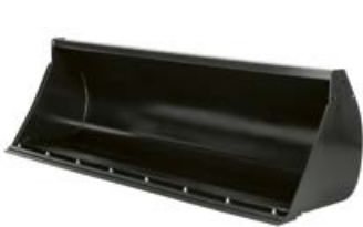
Cazo para tierra, BT púas atornilladas o cuchilla de desgaste
