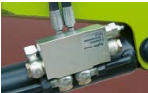
Gracias al cambio eléctrico en las series FL y FL C, las válvulas de seguridad son combinables con el sistema antivibración SHOCK ELIMINATOR.
