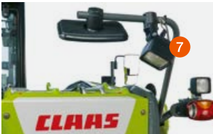
Focos halógenos en el soporte del espejo trasero para iluminar la zona trasera.
