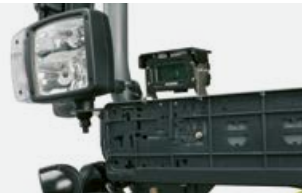
Una cámara de alta resolución en la parte delantera derecha ofrece imágenes nítidas también con poca luz.
