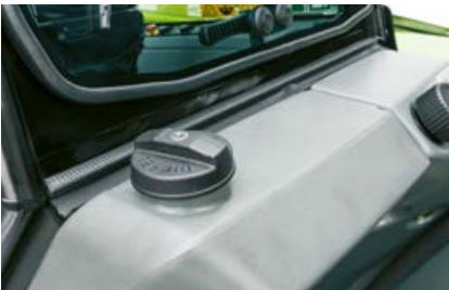
El depósito de combustible detrás de la cabina puede ser cerrado con llave.
