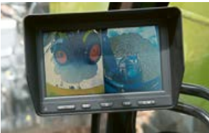
Las imágenes de las cámaras delanteras y traseras son transferidas al monitor de la cabina.
