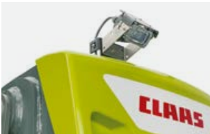
La PROFI CAM en la parte trasera ve todo lo que pasa a espaldas del operario.
