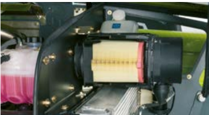
El filtro de aire del motor ofrece un excelente acceso, permitiendo realizar el mantenimiento sin herramientas.
