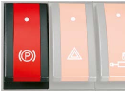
Con el interruptor de vuelco se puede activar manualmente el freno de estacionamiento.
