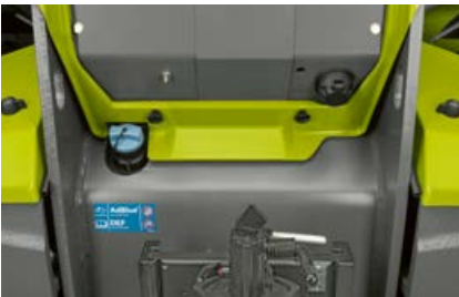
Racor de llenado del AdBlue muy accesible para un tratamiento eficiente de los gases de escape.
