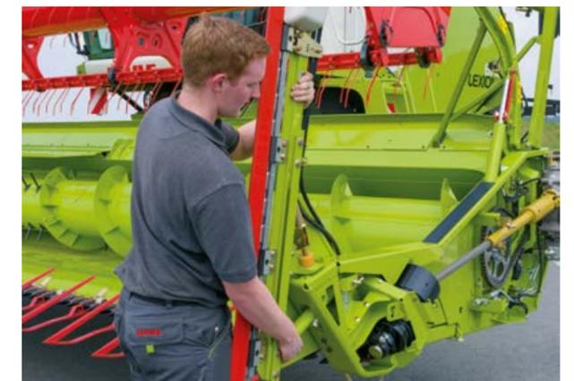
Montaje de las cuchillas de colza con cierre rápido
