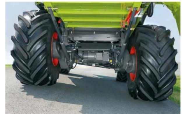
Eje delantero MONTANA con inclinación máxima
