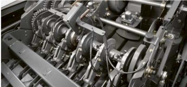
restos indeseados en la generación de energía. El sistema TURBO FAN accionado hidráulicamente, con su corriente activa de aire, protege los anudadores con una corriente de aire permanente de 140 km/h y repartidores de aire.
