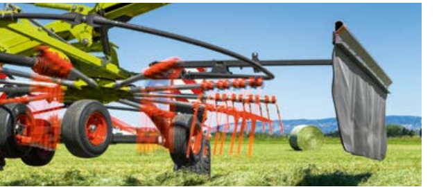
El exclusivo concepto de chasis de los hileradores laterales CLAAS permite alturas de elevación de hasta 70 cm.
