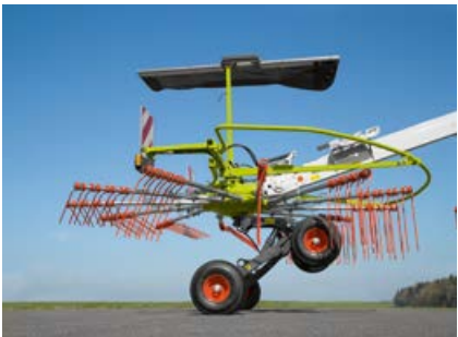
Gran altura de elevación para sobrepasar hileras en los cabeceros: Hasta 50 cm en el LINER 700 TWIN.
