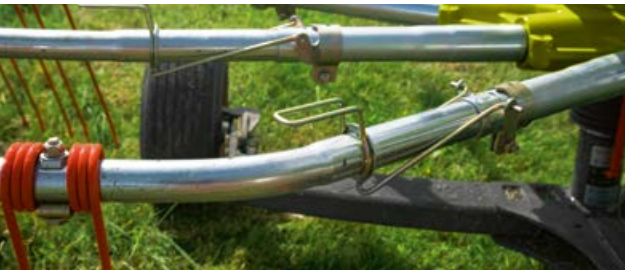
Protegido en caso de choque: Los brazos se doblan de forma controlada en un punto predefinido.
