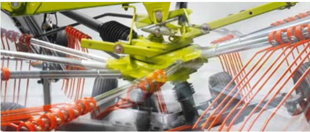
El enganche cardánico de rotores: Los rotores se adaptan al contorno del suelo independientemente del tractor.
