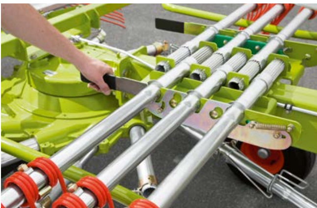
En algunos modelos se tienen que retirar brazos de púas para el transporte. Estos se pueden guardar rápidamente.
