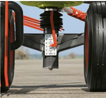
Seguir siendo flexible: Escala para graduar la altura de rastrillado
