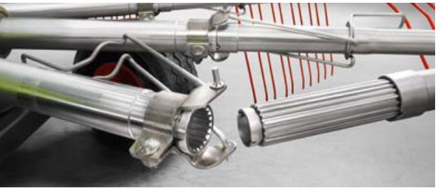
El seguro patentado de los brazos de púas PROFIX con dentado múltiple: Cómodo montaje y desmontaje de los brazos de púas.
