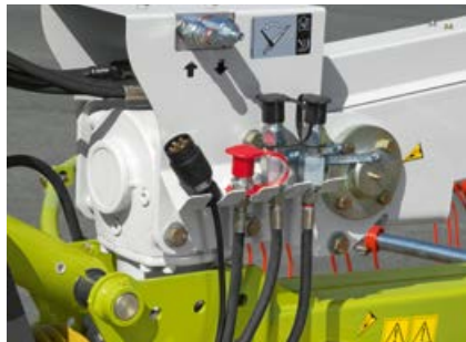
Mando secuencial hidráulico de serie para ajustar el retardo entre el rotor delantero y el trasero al subirlos y bajarlos.
