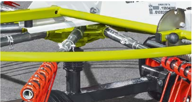
Unión de perfil limón y pasadores de fijación en LINER 370 y 320.
