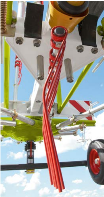
Las púas estándar de los modelos 450, 420, 370 y 320 son extremadamente estables con sus 9 mm, siendo adecuadas tanto para heno como para ensilado.
