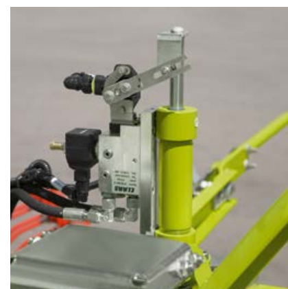
Los dos hileradores de cuatro rotores están disponibles como modelo confort con un reglaje electro-hidráulico de la altura de rastrillado.
