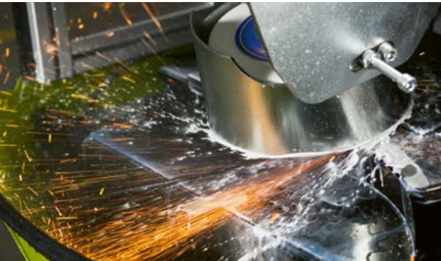
Con un ángulo de afilado siempre correcto se mantienen el radio original y el contorno de la cuchilla.
