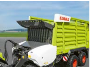
Tapa de relleno abatible hidráulicamente hacia delante.
