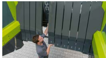
Colocar la cobertura del canal.
