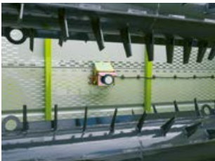
Sensor del nivel de relleno.
