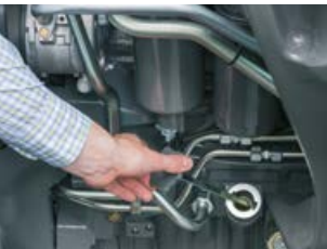
La varilla de medición del aceite del motor ofrece un fácil acceso también con el cargador frontal montado.
