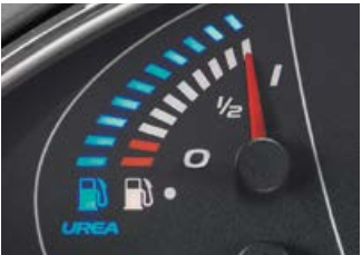
Indicadores del nivel de relleno de la solución de urea y del combustible a golpe de vista en el panel de instrumentos.
