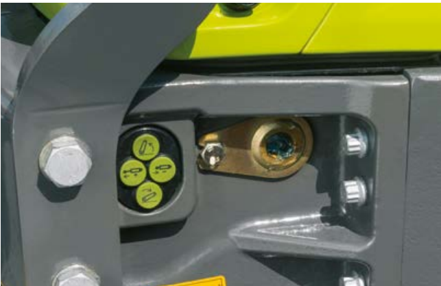
Con distribuidores electrohidráulicos también se pueden manejar de forma externa el elevador delantero y el distribuidor hidráulico adicional.
