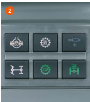
Panel de mandos de las funciones principales: Bloqueo del diferencial, doble tracción, modo de carretera y de campo, adición hidráulica de bombas y activación de la suspensión del eje delantero.
