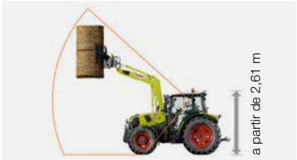
Cabina panorámica con parabrisas delantero continuo hasta el techo de cristal: Altura de paso a partir de 2,61 m.
