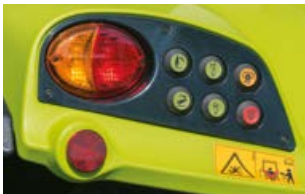
Es posible el manejo de un distribuidor electrohidráulico en ambos guardabarros.
