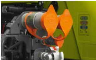
Aparatos acoplados con grandes necesidades hidráulicas son alimentados por el equipo Load-Sensing a través de las conexiones Power-Beyond.
