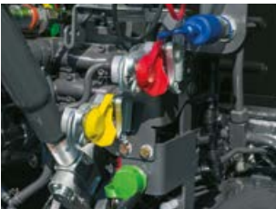
El equipo neumático de frenos y el freno hidráulico son también posibles en combinación.
