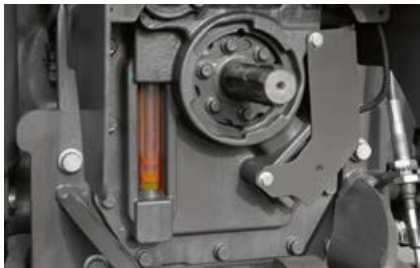
Fácil control del nivel de aceite de la transmisión y la instalación hidráulica en el cristal de observación junto a la toma de fuerza.
