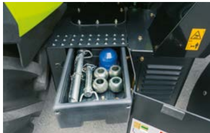
A la derecha en el acceso, bien a mano, se encuentra la batería y el espacio para guardar herramientas.
