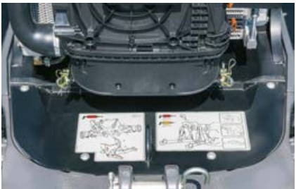
Debajo del capó del motor se encuentra un plano de lubricación que facilita el mantenimiento.
