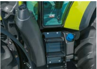
Conductos de relleno para 17 o 22 l de solución de urea y 140 o 190 l de combustible en el lateral de acceso izquierdo.
