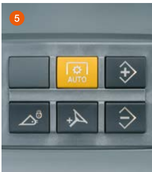
Panel de mando de las funciones adicionales: Interruptor de seguridad para el empestillamiento de la herramienta del cargador frontal, activación del automatismo de la toma de fuerza, activación de la dirección dinámica, ajuste de precisión de la memoria del régimen de revoluciones del motor.
