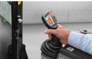
El manejo de los distribuidores electro-hidráulicos tiene lugar a través de las teclas basculantes proporcionales en la consola lateral y en el mando multifuncional integrado en ELECTROPILOT.
