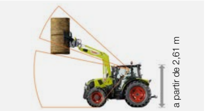
Cabina de techo alto con techo practicable de cristal: Altura de paso a partir de 2,61 m.
