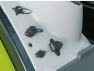
Conexiones ISOBUS en la cabina y en la trasera.
