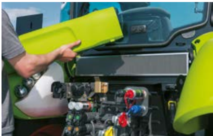
Fácil acceso al filtro de aire de la cabina detrás de la cabina.
