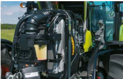
Fácil retirada del filtro de aire del motor delante de los radiadores.
