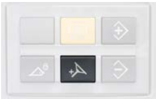
La dirección dinámica se puede conectar de forma rápida y sencilla pulsando un botón en la consola lateral derecha.
