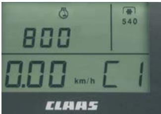
La marcha actual es mostrada en todo momento en el panel de mandos. En los equipamientos CIS+ y CIS adicionalmente en el montante A.
