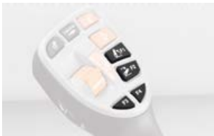
Las secuencias CSM son activadas confortablemente a través de las teclas funcionales en el mando multifuncional.
