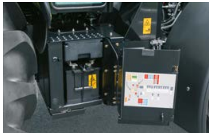
A la derecha en el acceso, bien a mano, se encuentra la batería y el espacio para guardar herramientas.
