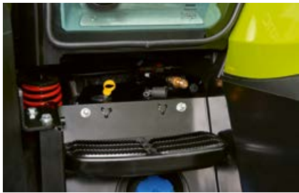
NUEVO: A la izquierda del acceso se encuentra una conexión de aire comprimido.
