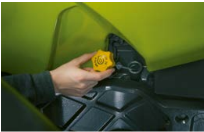
El control del nivel de aceite y el relleno son posibles con el capó cerrado.
