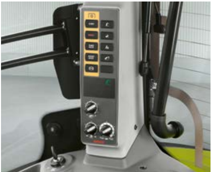
Regímenes de la toma de fuerza y regulación electrónica del elevador trasero ajustables en el montante B.
