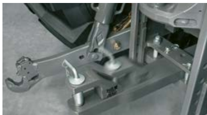
En las variantes de barra de tiro son posibles diferentes posiciones. La posición compensada mejora la maniobrabilidad.
