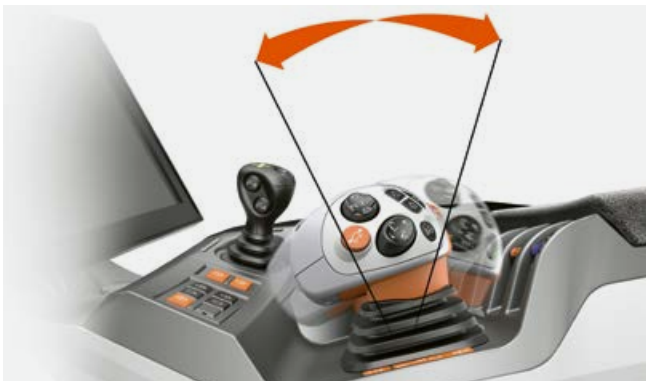
Manejo progresivo gracias a la tecnología de la caja de cambios continua CMATIC.
