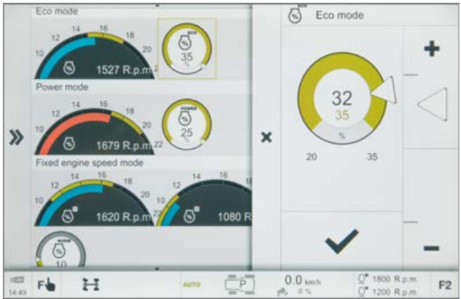
Ajuste de la carga del motor para "Eco" y "Power", así como para la memoria del régimen de revoluciones.
