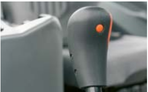
Con equipamiento REVERSHIFT y TWINSHIFT: Manejo del embrague electrónico pulsando un botón en la palanca de cambios.
