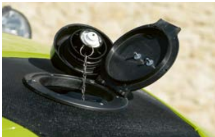
La abertura abatible en alto del capó del motor es muy práctica. Así se puede abrir y rellenar fácilmente el depósito que se encuentra protegido debajo.
