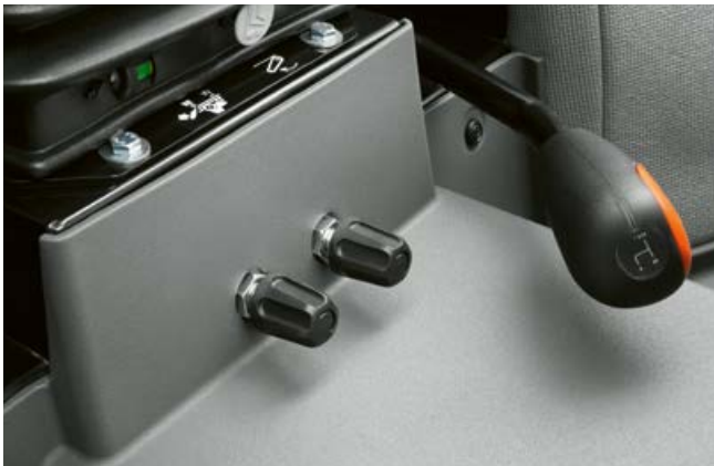
También con los elevadores traseros mecánicos se puede ajustar con precisión la velocidad de descenso y la sensibilidad del reglaje de la fuerza de tiro debajo del asiento del conductor.
