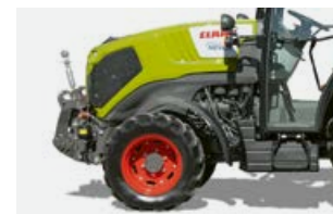
El elevador delantero plegable permite maniobrar de forma segura en los cabeceros gracias a su pequeño saliente.
