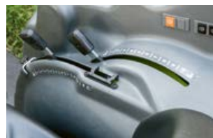
Usted elige entre la regulación mecánica y la electrónica del elevador trasero. Ambas están colocadas muy a mano a la derecha, junto al asiento del conductor.
