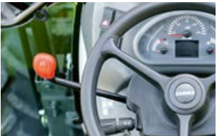
El cambio inversor siempre está a mano a la izquierda del volante, opcionalmente electrónico con REVERSHIFT o mecánico.
