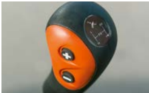
Para la caja de cambios de 24 marchas existe opcionalmente un doblador mecánico a la derecha del volante o la conmutación de carga TWINSHIFT que se maneja con la palanca de cambio de marchas.
