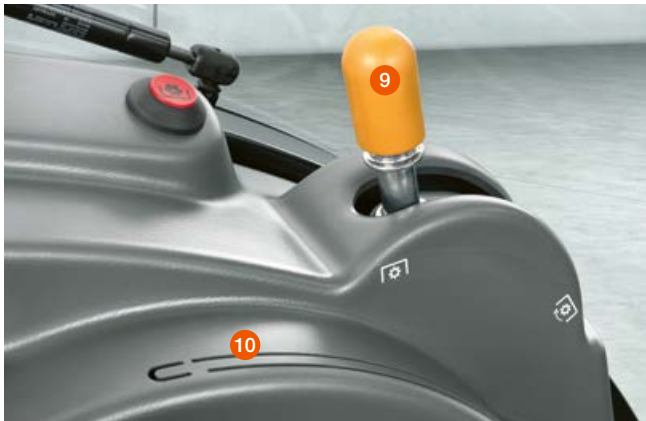
La toma de fuerza es conmutada hidráulicamente de serie. En las máquinas con cambio inversor REVERSHIFT y equipamiento TWINSHIFT se ofrece opcionalmente la conmutación electrónica de la toma de fuerza.
