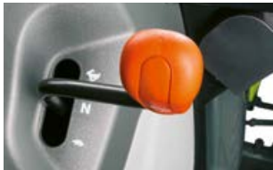
Para la caja de cambios de 24 marchas existe opcionalmente un doblador mecánico a la derecha del volante o la conmutación de carga TWINSHIFT que se maneja con la palanca de cambio de marchas.
