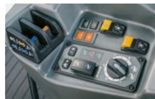
Usted elige entre la regulación mecánica y la electrónica del elevador trasero. Ambas están colocadas muy a mano a la derecha, junto al asiento del conductor.
