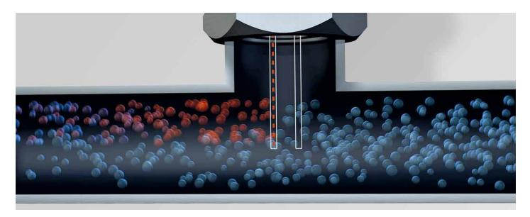
Dos sensores de temperatura están alineados uno detrás del otro en el sentido del flujo. El primero mide la temperatura actual, el segundo se calienta 40 grados Kelvin más que el primero; este se enfriaría a medida que aumenta el flujo másico, pero una resistencia eléctrica lo impide. La energía eléctrica necesaria para mantener la diferencia de temperatura es, por tanto, directamente proporcional al caudal volumétrico.
