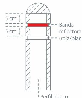
Los bolardos pueden ser con o sin bandas reflectoras. Sólo los bolardos con bandas reflectoras tienen el surco correspondiente.
