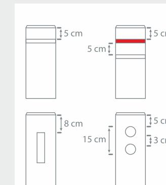
Palizadas y bolarados pueden ser equipados posteriormente con bandas y botones reflectores.
