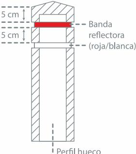
Los bolardos pueden ser con o sin bandas reflectoras. Sólo los bolardos con bandas reflectoras tienen el surco correspondiente.
