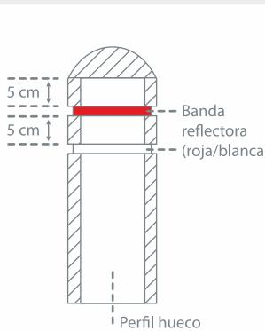
Los bolardos pueden ser con o sin bandas reflectoras. Sólo los bolardos con bandas reflectoras tienen el surco correspondiente.
