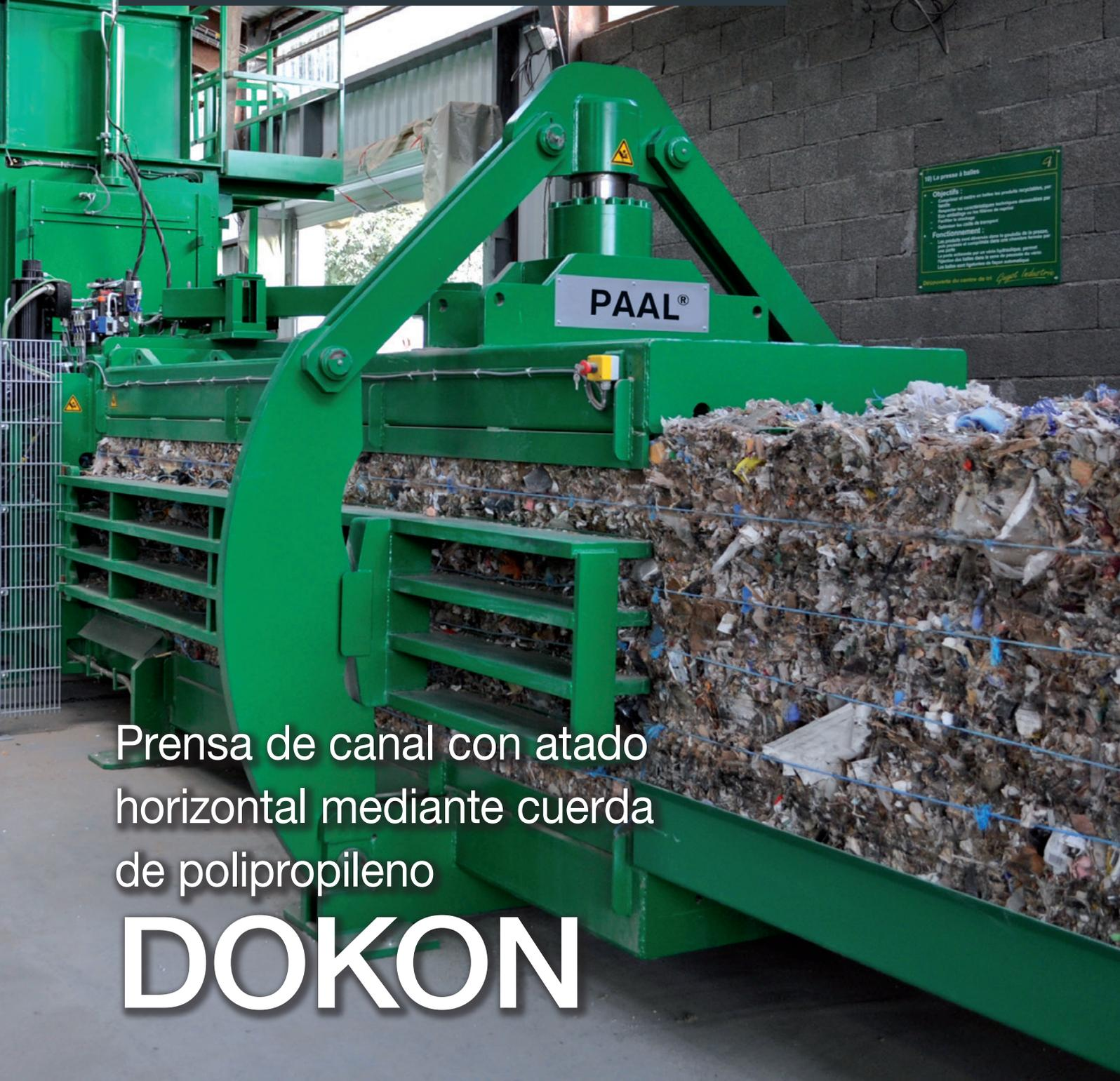
Prensa de canal con atado horizontal mediante cuerda de polipropileno
