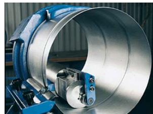
Sistema de corte flotante por roldanas
