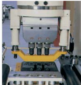
Unidad de punzonado triple (31/31/31 ó 31/40/31) para el punzonado del ala horizontal del ángulo y la llanta.
