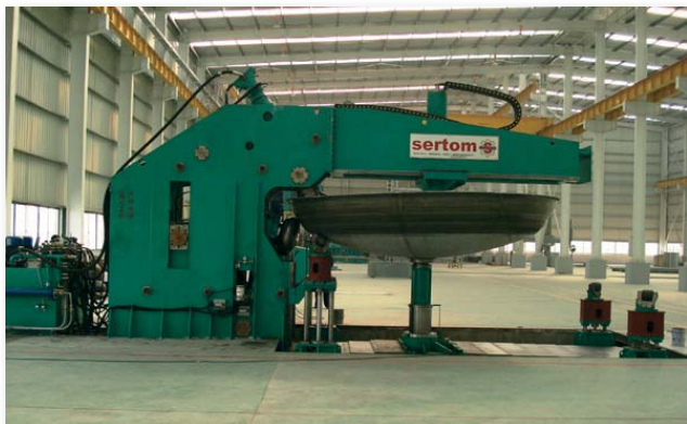
REBORDEADO Y CONFORMADO
