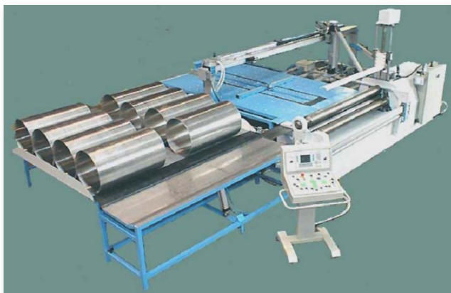
PRODUCCIÓN AUTOMÁTICA DE TUBOS
