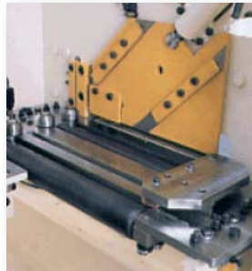
Guiado automático y sujeción hidráulica de material para el corte.
