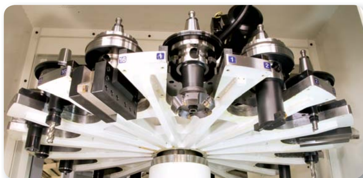
Cargadores de Herramientas de 12 / 60 pos.
