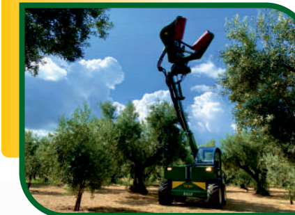
Braccio telescopico con sfilo da 1.450 mm Telescopic arm of 1.450 mm
