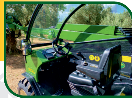
Cabina con roll bar e Joystick elettro-idraulico Protective roll bar and Electro-hydraulic joystick
