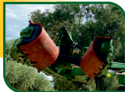
Movimento laterale della pinza sul piano orizzontale Lateral movement of the vibrating head on the horizontal plane
