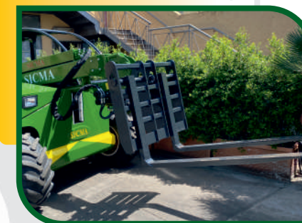
Multifunzione, con possibilità di agganciare forche muletto e forche letame Multifunction, with the possibility to couple it with forklift
