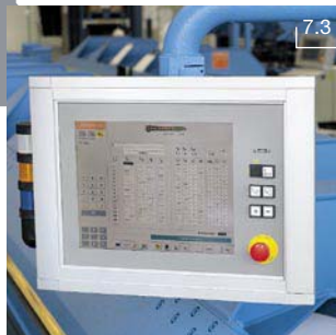
7.3 CNC5000- Mando con pantalla táctil y monitor TFT a color de 17". El mando opera con un procesador Pentium y basado en Windows, cuenta con tope trasero automático y con la posibilidad de dirigir un tope trasero cónico. El suministro incluye un programa de dibujo CAD (información más detallada en nuestro folleto especial).
