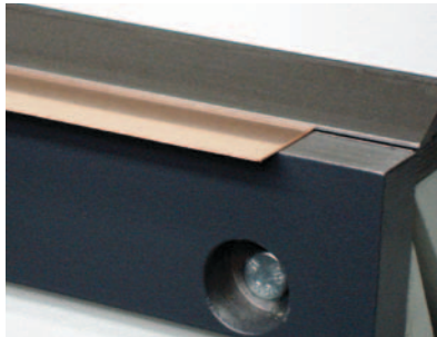
Ajuste de la trancha de plegado para material de bajo calibre y de calibre más grueso.
